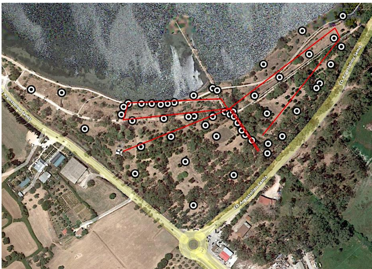
Σχήμα 5. Ανάπτυξη πειραματικής οπτικής ίνας, ~1.5 χιλιόμετρο (κόκκινη γραμμή) και ταυτόχρονη εγκατάσταση πλέον των 50 σειсмоγράφων (λευκοί κύκλοι) μέσα στο πάρκο του Κουτάβου, Αργοστολίου.
